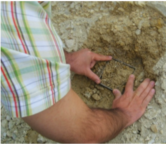
Şekil 5. Suyla ıslatılmış pasadan örselenmemiş örnek alımı.
